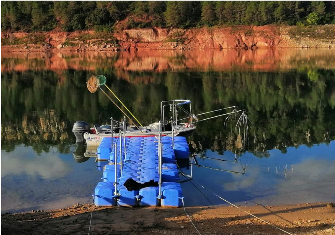
Figura 10. Equipo de electropesca desde embarcación preparado para el muestreo en el embalse de Guiamets
