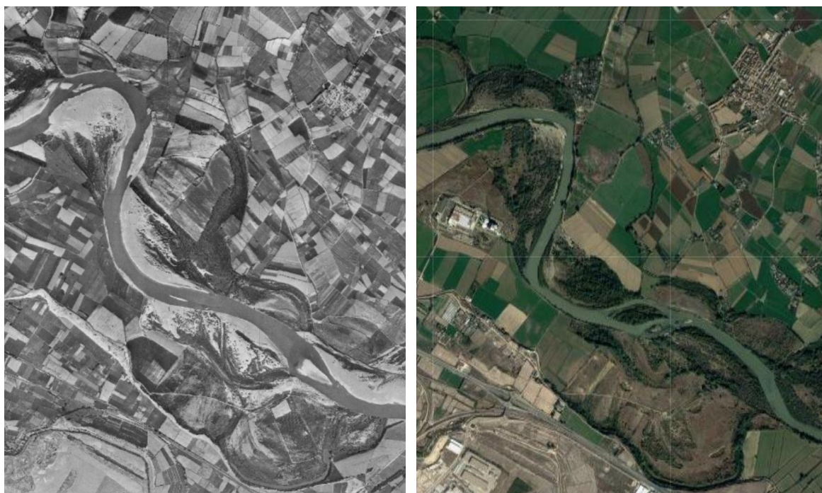
Figura 4: Tramo del Río Ebro a la altura de Pastriz en el año 1956 (izquierda) y en la actualidad (derecha). Se aprecia la casi total desaparición de las barras de gravas, la reducción de la anchura del cauce de aguas bajas y el mayor desarrollo de la vegetación de ribera, así como la ocupación de antiguos sotos por campos de cultivo.
