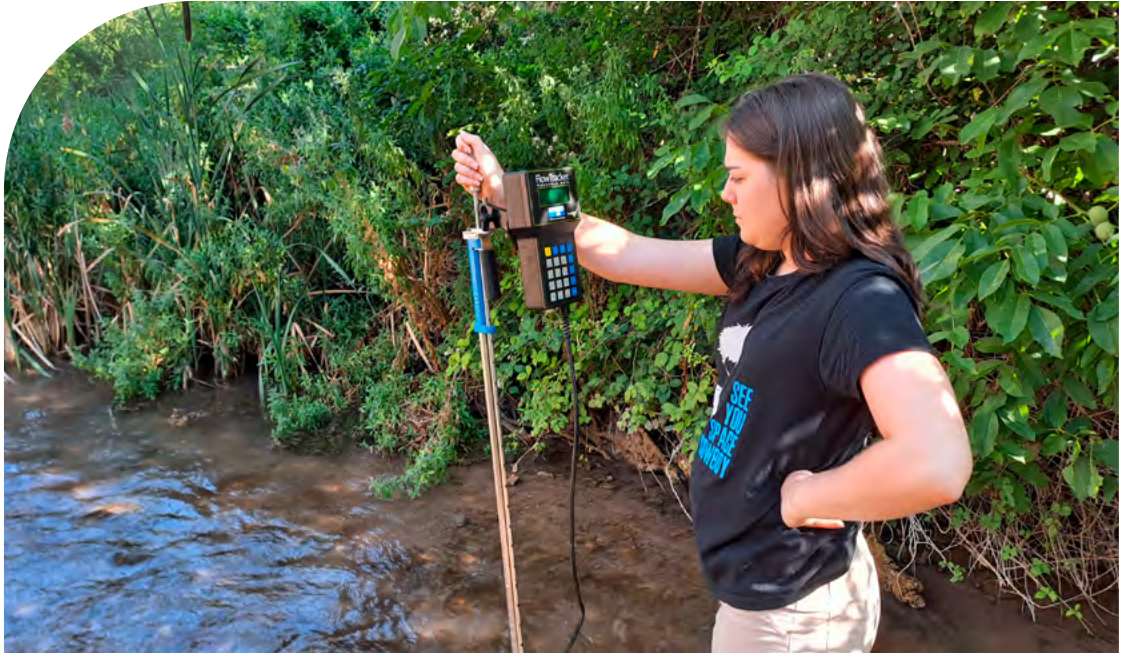
Medición de caudal con tecnología Doppler
